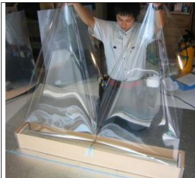
フィルムの断裁は採寸したサイズの幅20～30mm 長さ50mmほど大きく切る。
